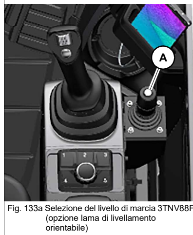
Fig. 133 Selezione delle marce 3TNV88F
