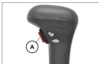
Fig. 133 Selezione delle marce 3TNV88F
