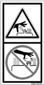
Abb. 26: Behälter steht unter Druck
